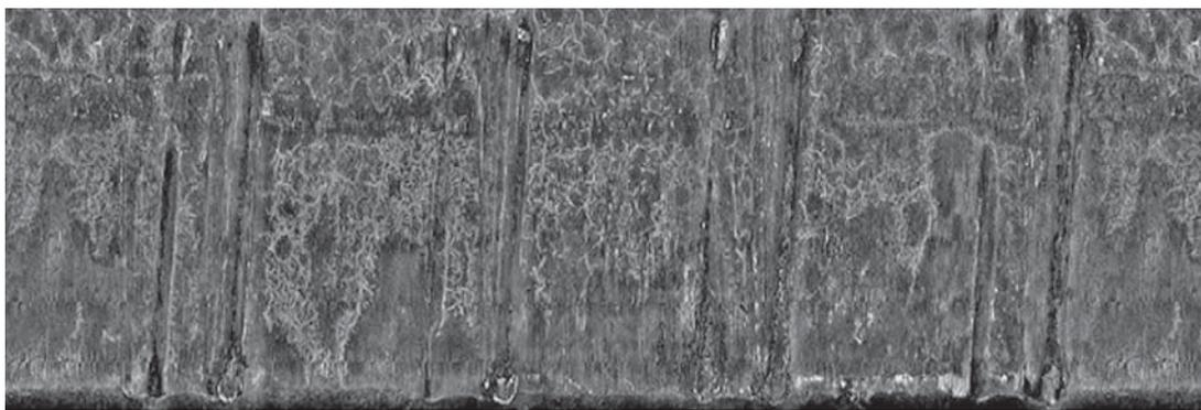
Рис. 3. Фоторазвертка ведущей поверхности выстреленной пули, подвергшейся термическому воздействию (температура 750 °С, время обжига 20 мин)
