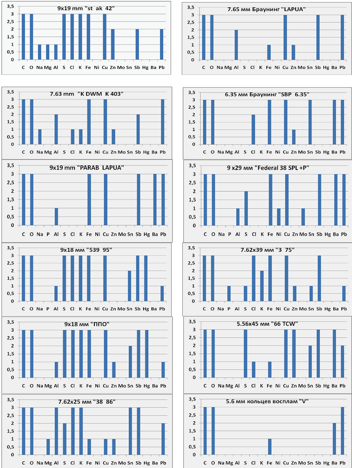
Рис. 3. Элементный состав продуктов выстрелов, произведенных различными патронами
