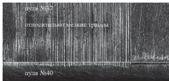
Рис. 2. Совмещение трасс, образованных лазерной маркировкой внутри ствола при однократном воздействии лазерного луча
