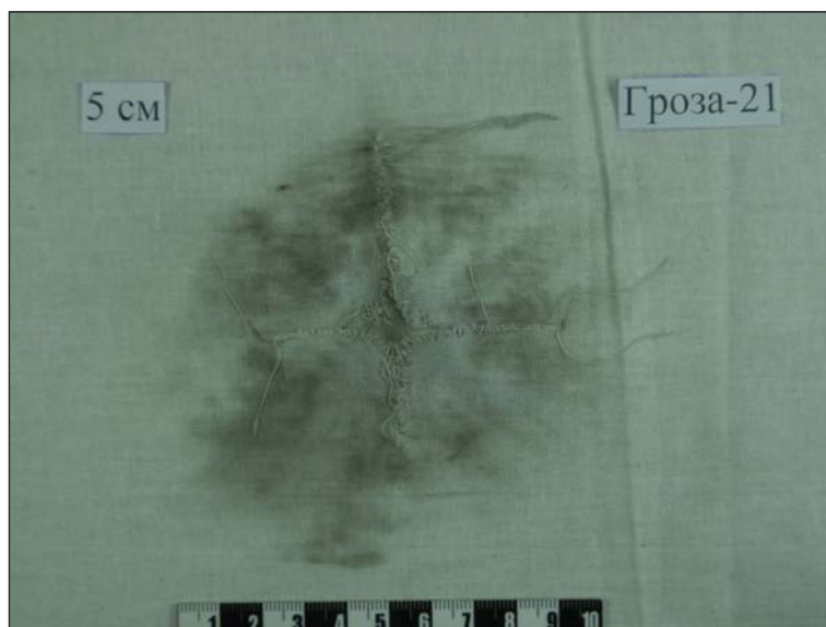
Рис. 5. Экспериментальная мишень. Повреждение, образованное при выстреле из пистолета «Гроза-021» с дистанции 5 см от дульного среза ствола пистолета до мишени
