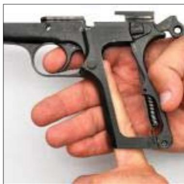
Рис. 3. Нейтрализация магазинного предохранителя
