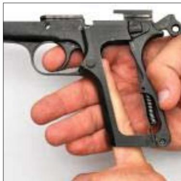
Рис. 3. Нейтрализация магазинного предохранителя
