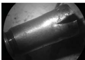
Рис. 1. Продольные разрывы дульца гильзы патрона МПЦ калибра 5,45 мм к пистолету ПСМ после выстрела из пистолета «Маузер К 96» образца 1896 г.
